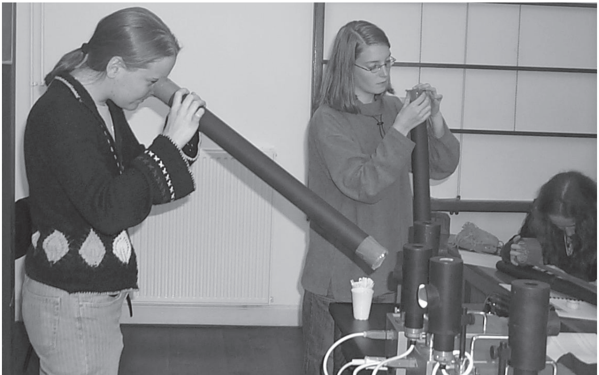
Met de zelfgebouwde spectrometer (bestaande uit een zwarte koker, een dia met fijne lijntjes en een spleet) worden de spectra van diverse spectraallampen bekeken
