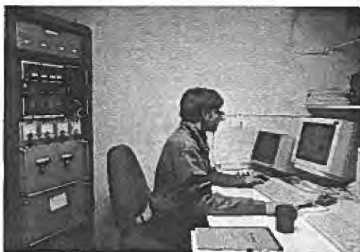
Felix Bettonvil in de waameemkamer van de DOT in het Zweedse huis. Links is de voeding en besturing van de motoren te zien, rechts de beeldschermen voor de besturing en de beeldinname (Foto Aswin Jägers)
