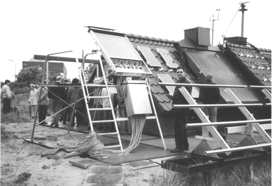
Opstelling voor onderzoek aan zonnecellen bij ECN in Petten.
