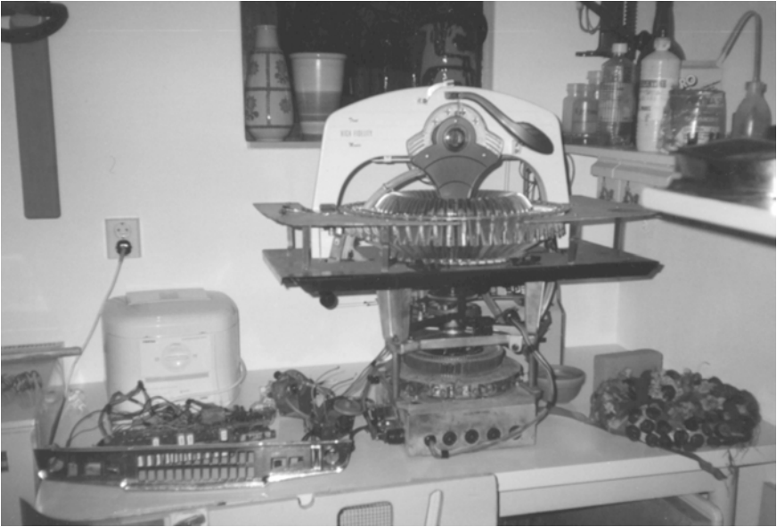
Het selectiemechanisme van de Wurlitzer 1900
