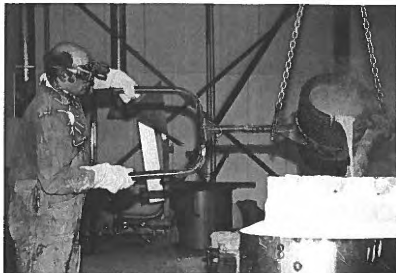
Het roodgloeiende brons wordt in de vorm gegoten
