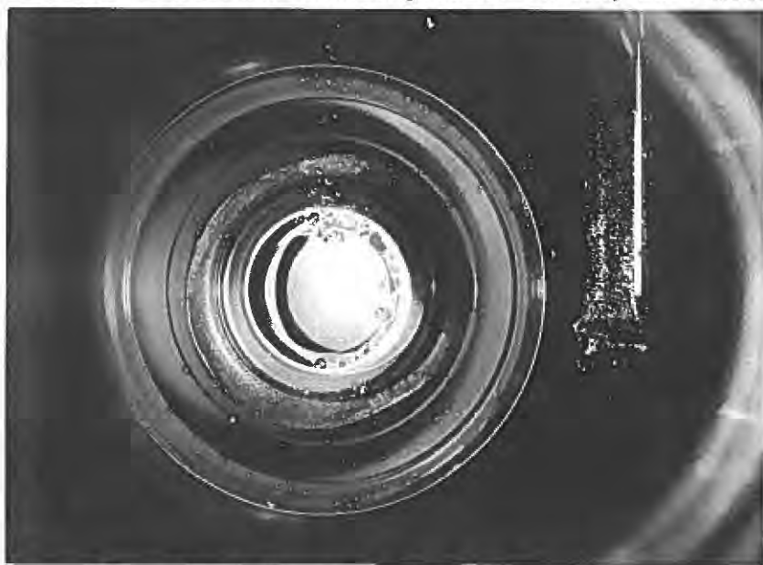
Foto-elektrochemische splitsing van water. Ontwikkeling van \text{O}_2 aan de \text{SrTiO}_3 -elektrode en van \text{H}_2 aan het platina draadje rechts. Zie bovenstaand en volgend artikel.
