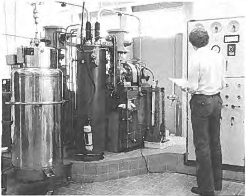
De heliumliquefactor. Links een voorraadvat van 100 liter; rechts een deel van het bedieningspaneel. De machine draait zonodig dag en nacht.
