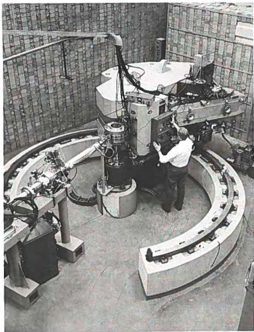
Bram Vermeer bij de 'split-pole' magnetische spectro- graaf in het Van de Graaff-laboratorium. Een kunststukje, hoe u het ook draait.
