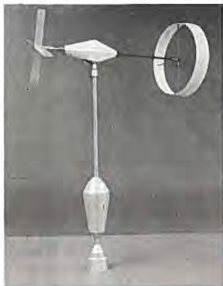
De zogenaamde trivane, waarmee de totale windvektor kan worden gemeten. Dit instrument is ontwikkeld op het KNMI en voornamelijk in gebruik voor drie-dimensionale turbulentie-metingen. KNMI Wetenschappelijk Rapport 78-11. (foto: KNMI).
